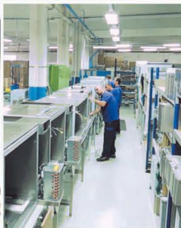
Pianowanie / Montaż Foam insulation / Assembling
